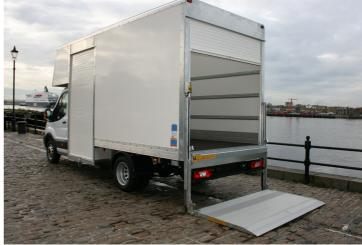
ELECTRIC TAIL LIFT AND ROLLER SHUTTER DOOR AT REAR
