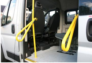
AUTOMATIC SIDE STEP OPENS WHEN SLIDING SIDE DOOR IS OPENED
