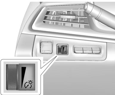
تعمل هذه الميزة على ضبط سطوع جميع عناصر التحكم المضاءة.
